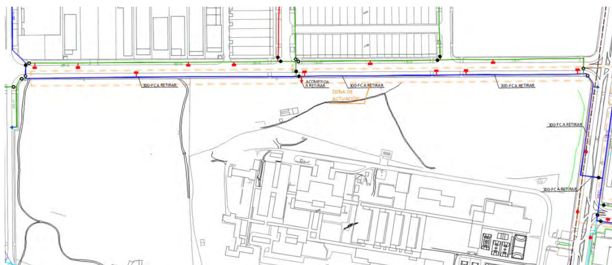
Estado actual instalación de abastecimiento del entorno
